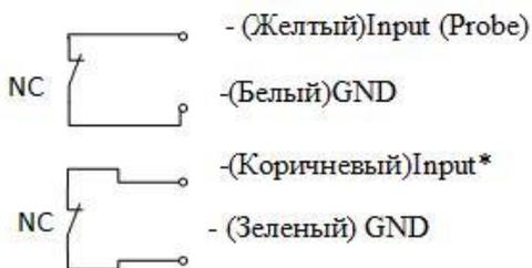
Прибор имеет четырех проводное подключение: Gnd, Out (Input\*), Gnd, Out (Probe). Во время работы на выходе Out присутствует напряжение, в момент нажатия кнопки фрезой, внутри прибора размыкается контактная пара - напряжение на выходе Out (Input) становится равным нулю - происходит замедление движения фрезы.
